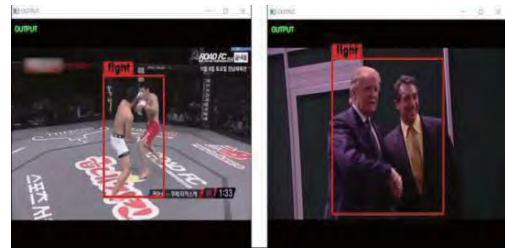
[그림 2] Object Detection 기반 폭력 탐지 결과
