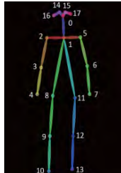
[그림 4] OpenPose 를 이용한 관절 좌표 정보
