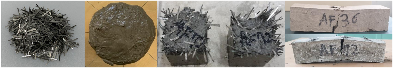
그림 1. 비정질금속섬유 생산 및 실험과정
