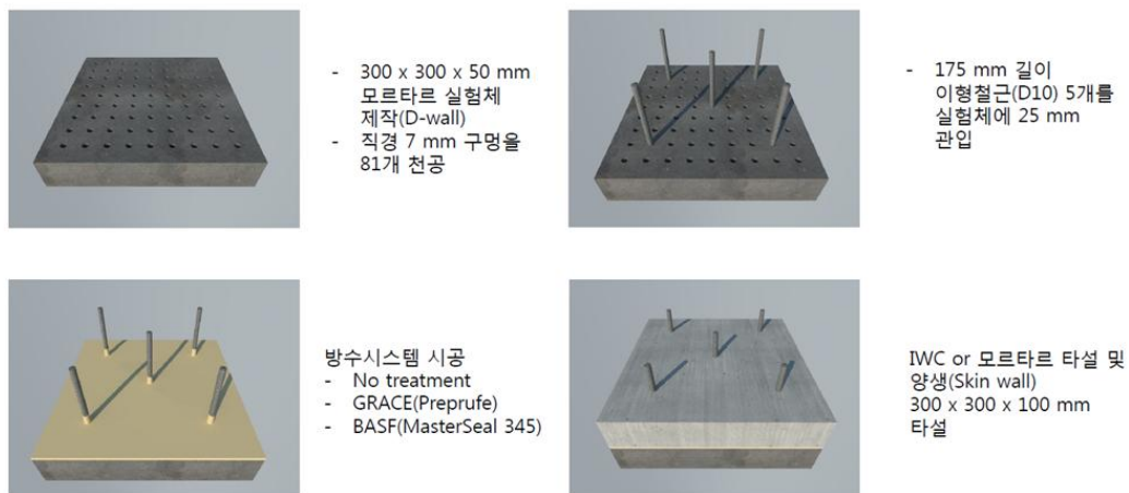
그림 2. 구조물 누수에 대한 방수시스템 개발
