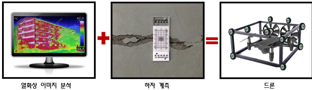
그림 1. 드론을 활용한 누수 및 균열 모니터링 시스템
