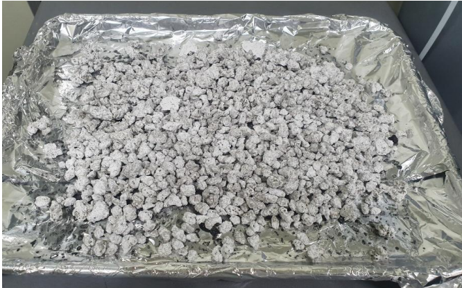
그림 1. TiO 2 로 코팅된 기포 콘크리트 골재
