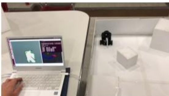
Fig. 2. SLAM을 이용한 장애물 회피 주행실험
