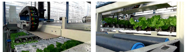
홀티플랜(Hortiplan)의 재배베드자동이송시스템(MGS: Mobile Gully System)
