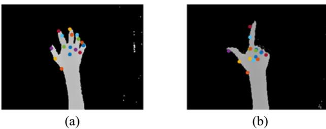
(그림 4) 3D Egocentric DB 예시. (a) & (b) 웹캠 손영상 및 16 조인트 위치
