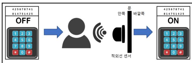
(그림 7) 적외선 센서를 이용한 내부 기능 제어
