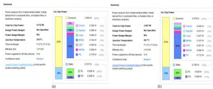
[그림 5] 32bit 부동소수점 기반 인지컴퓨팅 엔진 전력소비량(a)과, 16bit 고정소수점 기반 인지컴퓨팅 엔진 전력소비량(b)
