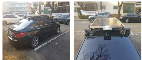
그림 1 태양광 모듈 탑재 차량 Fig. 1 vehicle with PV module
