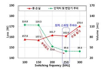
분석은 1차측 ZVS 동작 및 2차측 동기정류 동작을 고려하여 진행하였으며 전체 손실에 영향이 적은 항목은 분석에서 제외하였다. 그림 3은 인덕터 및 변압기의 손실을 나타낸 것으로, high flux 코어의 코어 손실은 steinmetz 방정식을 통해 계산하였고, ferrite 코어의 코어 손실은 제조사의 datasheet를 기반으로 계산하였다. 그림 4는 스위칭 주파수에 따른 총 손실과 코어의 부피의 변화 양상을 나타낸다. 그림 4에서 스위칭 주파수에 따라 공진 인덕터 및 변압기의 코어 size가 급격히 감소하는 구간이 있는 반면, 총 손실이 급격히 증가하는 구간도 존재한다. 따라서 본 논문에서는 효율과 전력밀도를 모두 고려하여 PSFB 컨버터의 스위칭 주파수를 250 [kHz]로 선정하였다.
