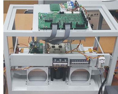
그림 6 단상 3레벨 인버터 하드웨어 프로토타입 Fig. 6 Single-phase 3-level Inverter hardware prototype
