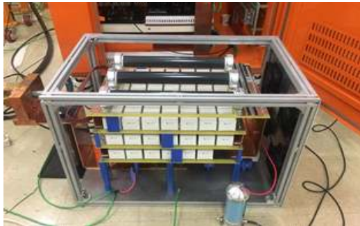
그림 2 프로토타입 반도체 스위치 기반 키커 모듈레이터 Fig. 2 Prototype Kicker Modulator Based on Solid-State Switch
