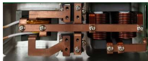
그림 2 변압기와 출력 필터 인덕터 Figure 2 Transformer and output Filter inductor
