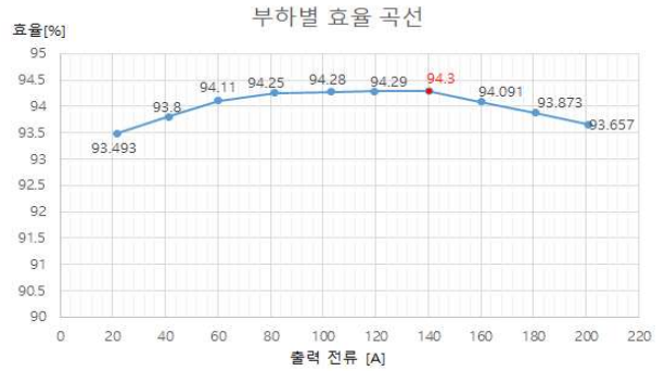
그림 LDC 시작 의 부하 Fi icienc Cur e o LDC Protot pe
