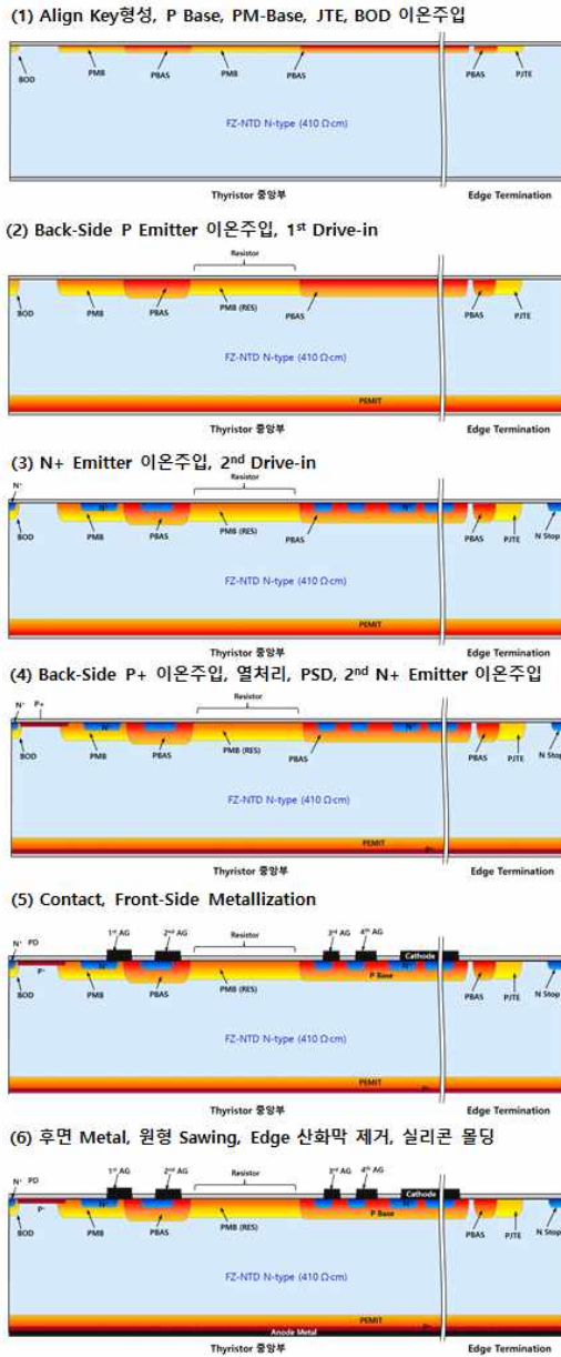
그림 2. LTT 소자의 process flow Fig. 2 Process flow of LTT device
