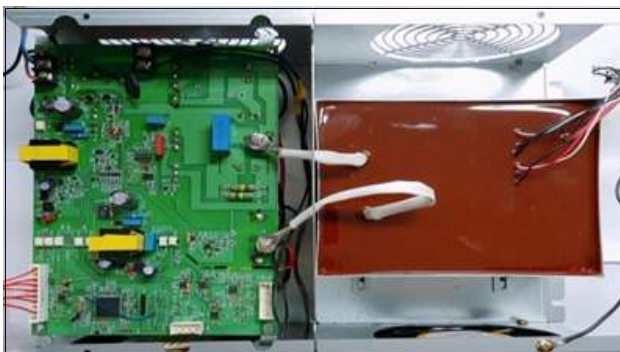
그림 9 제안 고전압 저속 스위칭 전력단 PBA 및 트랜스
