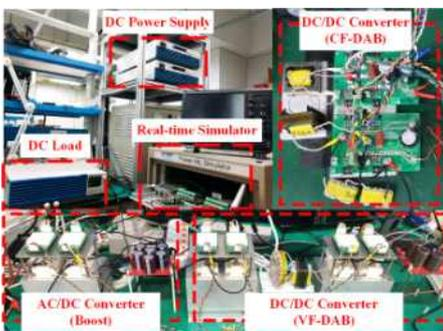
그림 6 PHIL 가상 DC 마이크로그리드 Test-Bed
