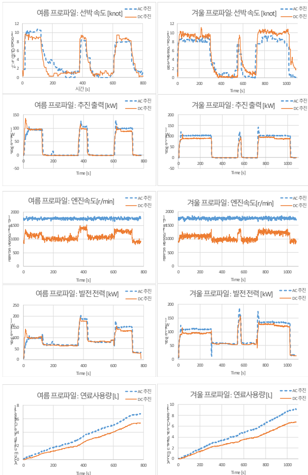
그림 3 여름, 겨울 부하 프로파일에서 DC, AC 선박의 속도, 추진 출력, 엔진속도, 발전 전력, 그리고 연료사용량 Fig. 3 Ship speed, propulsion power, engine speed, generated power, and fuel usage for DC, AC IEP ship
