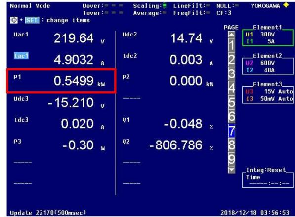
그림 9는 입력 220Vac 조건에서 전체 시스템 효율을 보여준다. 측정은 제안된 모든 컨버터를 연동하여 풀 부하 조건에서의 입력 전력을 측정하였고, 입력 전력은 약 550W로 측정되었다. 출력 전력은 500W 풀 부하이므로 이를 통해 제안된 컨버터의 전체 효율을 계산할 수 있다. 전체 효율은 90.9%로 이는 가장 전류가 많이 흘러 효율이 낮은 220Vac 조건에서 측정한 결과이므로, 380Vac /800Vdc 조건에서는 효율이 훨씬 더 좋다.
