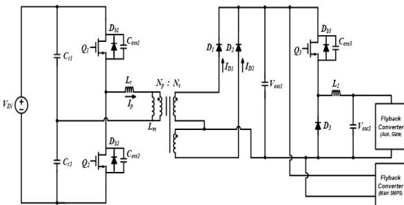
그림 3는 제안하는 넓은 입력범위를 갖는 고효율 SMPS 토플로지 구조를 보여준다. LLC 공진형 컨버터의 출력은 Flyback 컨버터(Main SMPS)와 Buck 컨버터의 입력전압으로 사용되고, Buck 컨버터의 출력전압은 FAN 전원과 다른 Flyback 컨버터(Aux SMPS, Gate SMPS)의 입력전압으로 사용된다. 그리고 Flyback 컨버터의 출력은 GND가 분리된 보조 SMPS의 전원으로 사용된다.
