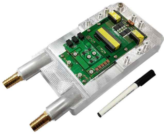
그림 6. 1.8kW LDC 2차 시제품 제작 사진
