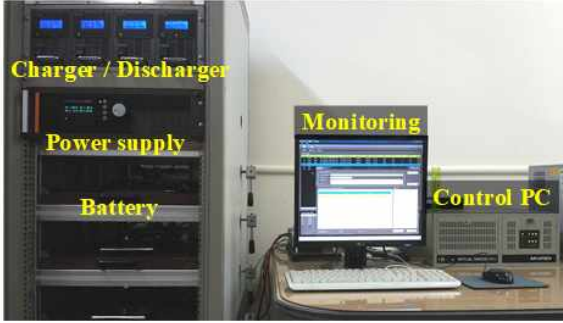
그림 5 검증을 위한 실험 환경 Fig. 5 Experimental set-up for verification.
