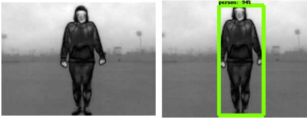
그림 6 MobileNet기반SSD 열적외선 카메라에서의 객체 검출(5M)
