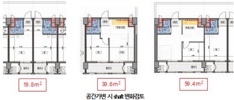
그림 1. 공간가변을 적용한 장수명주택 평면안
