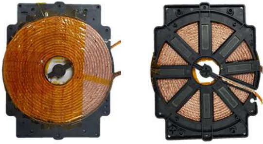
(a) 상단 (b) 하단 그림 3 캠핑용 Induction cooker용 워킹 코일 Fig. 3 Working coil for induction cooker for camping.
