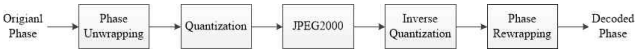
그림 2. 제안하는 위상 펼침 기반의 압축 코덱 Fig 2. Proposed Compression Codec Using Phase Unwrapping Techniques
