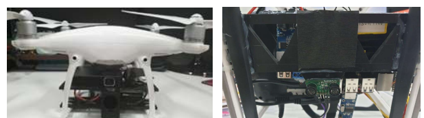
(a) 전면부 (b) 하단부 그림 1. 드론 탑재형 프로젝트 시스템의 하드웨어 구성
