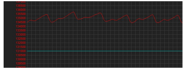
그림 3. 심박 센서가 측정된 PPG 신호
