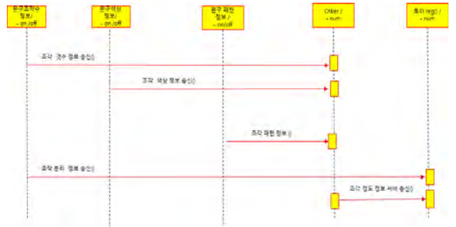
그림 7. 완구 상태 신호의 처리 동작 시나리오 (완구의 구성 형태 및 모양 상태 점검)
