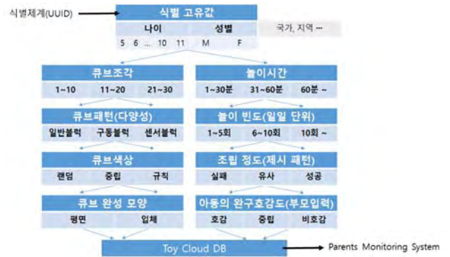
그림 3. 스마트 토이를 활용한 수집 데이터 분석 모델
