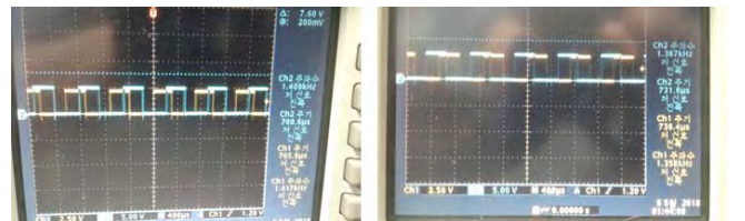
(그림 6) 엔코더의 홀센서 펄스 파형 (좌, 정회전 /우, 역회전시 홀센서 파형 위상차)
