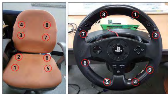
그림 4. 시트와 스티어링 휠에 실제 부착된 진동 모터
