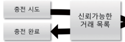
① 충전 하기 : 충전금액을 입력하면 충전을 위한 프로세스가 진행된다. 이 때, HTTP framework 방식으로 서버와 매개변수를 주고 받는다.
