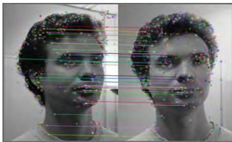
(그림 3: Open CV library를 사용한 안면인식)
