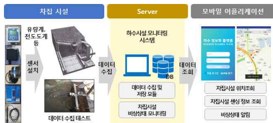
그림 1. 하수시설 모니터링 시스템 구조
