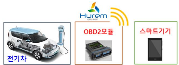
그림 1 전기차 주행 및 충전시 실시간 배터리 정보 취득시스템. (주)휴렘 개발
