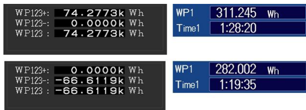
그림 5 Cycle 1 효율 계산을 위한 충,방전 및 보조전력 Fig. 5 Charing, discharging and auxiliary active power for cycle 1 calculating Roundtrip efficiency
