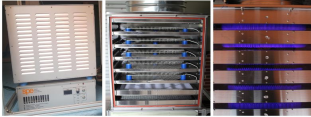
그림 3-a. 전원장치 3-b. 반응기 3-c. 방전모습 표 1은 전원장치의 사양을 나타내었다.
