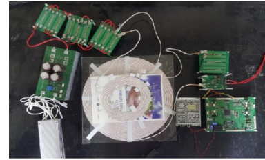
그림 4 무선전력전송 시스템 Hardware Fig. 4 Wireless power transmission system Hardware
