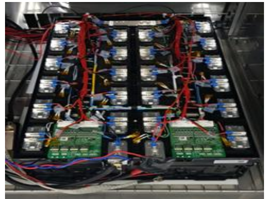
그림 1. 실제 실험에 사용된 24S1P 대용량 배터리팩
