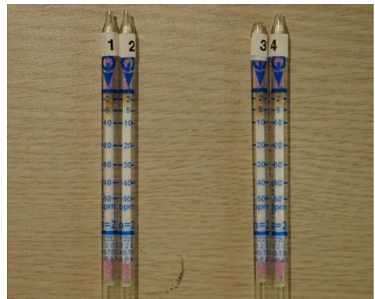
그림 6 가스처리 전/후 톨루엔 농도비교 사진 Fig. 6 Comparison of toluene concentration before and after gas treatment
