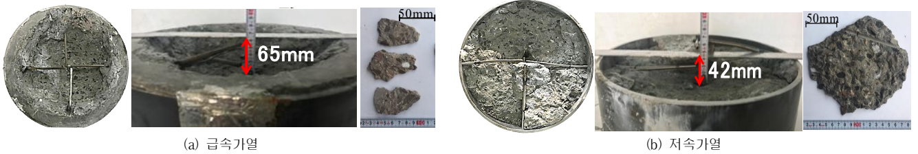
그림 1. 가열조건에 따른 링형 구속 콘크리트의 폭발특성
