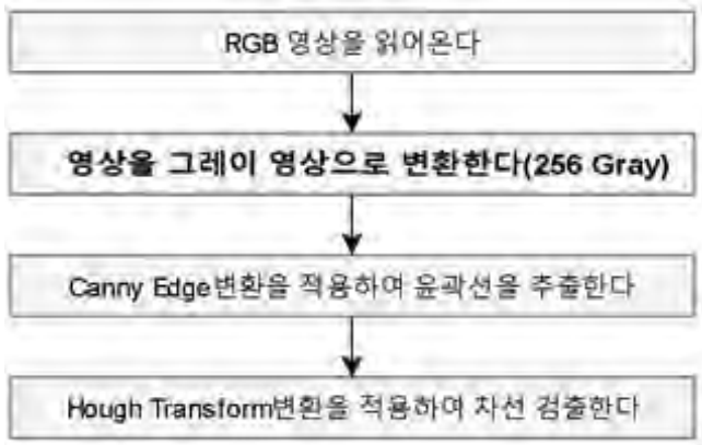
(그림 2) Hough Transform 변환 적용 차선검출 순서도
