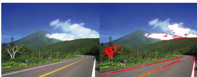
(그림 4) RGB 색상모델을 적용한 Hough Transform변환
