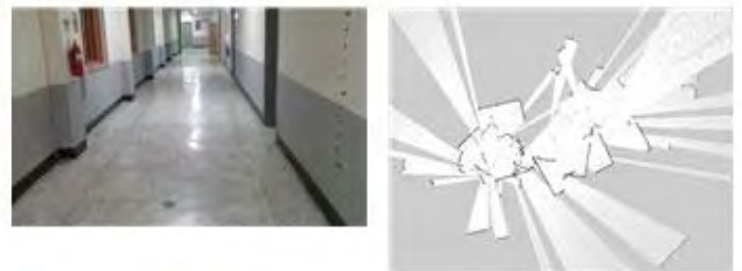
그림 4 실제 환경과 파라미터를 수정 전 Mapping 된 지도
