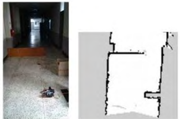
그림 5 실제 환경과 파라미터를 수정한 후 Mapping 된 지도
