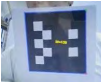
그림 1 Aruco Marker ID표시
