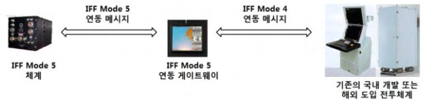
(그림 1) 실장비 환경에서의 IFF Mode 5 연동 게이트웨이 운용개념도
