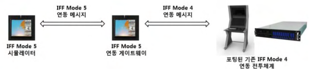
(그림 2) 프로젝트 환경에서의 IFF Mode 5 연동 게이트웨이 운용개념도
