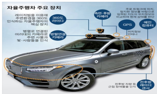
그림 2. 자율주행자동차의 주요 장치[1]
