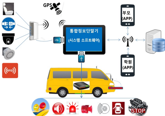
그림 1 전체 시스템 구성도
