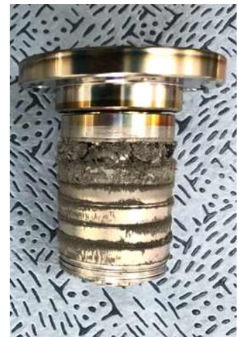
그림 17 터보 분자 펌프에서 파손이 발생한 경우의 다축 자동 제어 모듈의 핵심인 자기 베어링의 손상 형태
