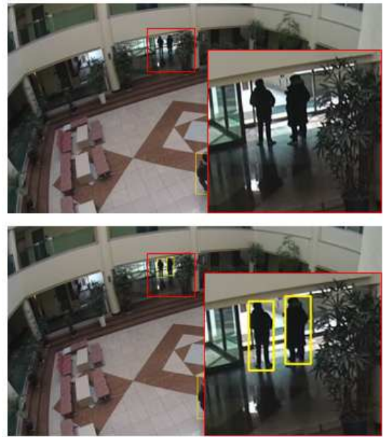
그림 4 YOLO 네트워크의 보행자 검출 결과 비교 변경 전(위)과 변경 후(아래)
