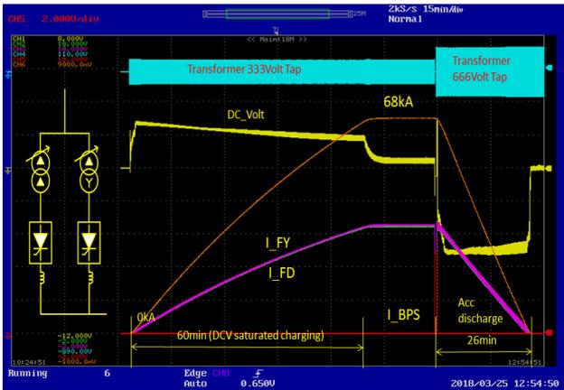
그림 4 ITER TF AC/DC 컨버터 666V Tap operation 파형
