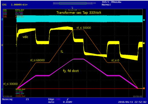
그림 3 ITER TF AC/DC 컨버터 333V Tap operation 파형
