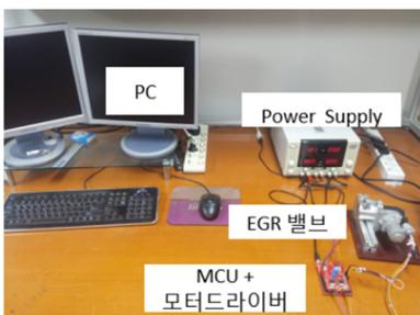
그림 3 테스트 벤치
