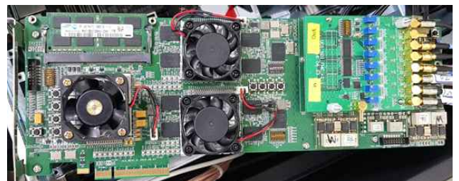
그림 2. FPGA 기반 멀티채널 UHD 영상 녹화/재생 하드웨어 플랫폼
